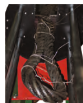
Заведение петли каната в поворотный зажим
