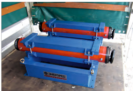
ЦС200Г1250Ш в составе установки для прокола грунта
