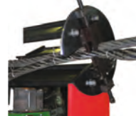
Заведение петли каната в поворотный зажим
